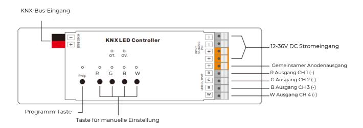
Der **Dimmer mit LED-Konstantspannungsantrieb** kann LEDs direkt steuern und verfügt über vier unabhängige Kanäle. Die elektrische Verbindung der Geräte erfolgt über PUSH-Klemmen, während die Verbindung zum EIB/KNX-Bus über eine Busanschlussklemme hergestellt wird. Am Eingang muss eine Betriebsspannung von 12V-36V DC angeschlossen werden. Die folgende Liste bietet einen Überblick über die Funktionen:
